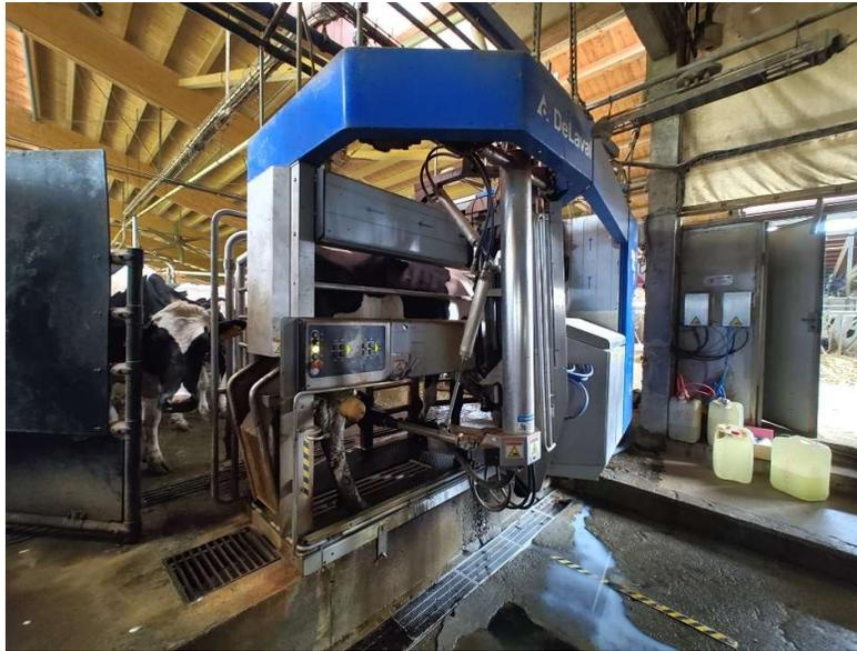
**Figura 16.** Immagine di una delle unità di mungitura automatizzata presenti nell'allevamento dell'azienda Filippini.
